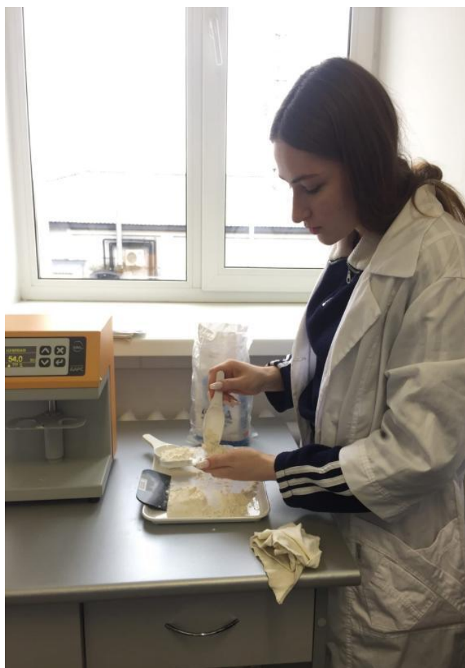
Определяем белизну муки на белизномере «Барс»
