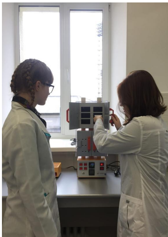
Определяем влажность крупы в сушильном шкафу АСЭШ-8-2
